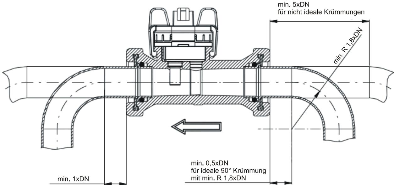
**Die Flussrichtung ist unbedingt zu beachten** (am Sensor durch einen Pfeil gekennzeichnet). Die Einbaulage ist beliebig.
