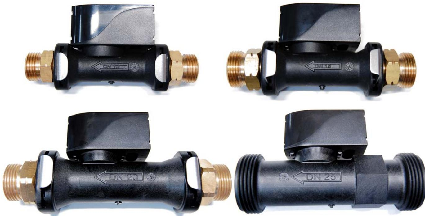
Die elektronischen Volumenstromsensoren FTS...DL basieren auf dem Prinzip der Karman'schen Wirbelstraße. Die Wirbelablösung an dem in der Strömung stehenden Staukörper erfolgt streng proportional zur Strömungsgeschwindigkeit. Die erzeugten Wirbel werden durch ein piezoelektrisches Paddel detektiert und durch die integrierte Elektronik ausgewertet. Ein Mikroprozessor wandelt die analogen Messwerte in ein für den DL-Bus (Datenleitung) geeignetes serielles Digitalsignal um.
