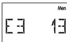
Hier wurde dem externen Sensor **E3** der Sensorwert der **Adresse 1** mit dem **Index 3** zugewiesen, das ist der Wert eines Temperatursensors PT1000, der an den FTS-Sensor angeschlossen ist.
